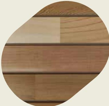
**L'aboutage** est un procédé d'assemblage qui permet de fabriquer des pièces de bois longues et homogènes à partir de bois courts ou de bois présentant des défauts. Les éléments sont reliés entre eux par des entures en dents de scie, puis collés dans le sens longitudinal.
