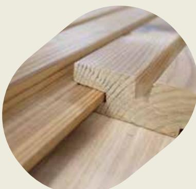
**Les profils à emboîtement** sont conçus pour assurer un assemblage fermé entre les lames, grâce à un système de rainure et languette. Ce principe d'emboîtement garantit une pose continue et sans jour, tout en facilitant l'alignement des lames et en assurant une bonne tenue mécanique de l'ensemble.
